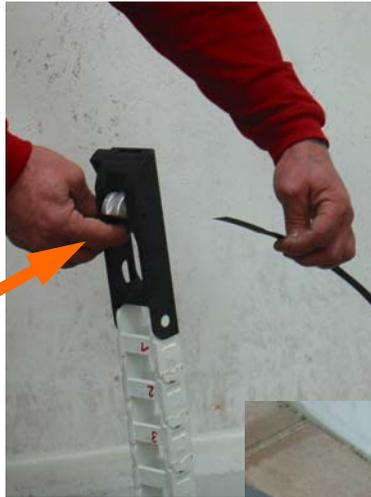
Stecken Sie dann das Packband wie abgebildet von hinten durch das Kopfstück der Kettenlanze. Das Packband muß dabei unter dem Excenter durchgeschoben werden
