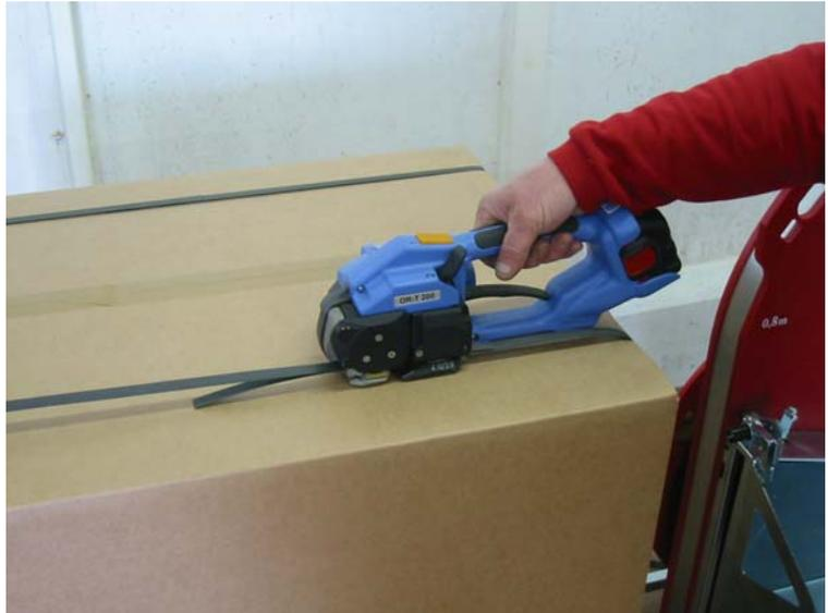
Nach dem Spannen und Verschweißen des Bandes schneidet das Verschlußgerät das überstehende Bandende ab.
