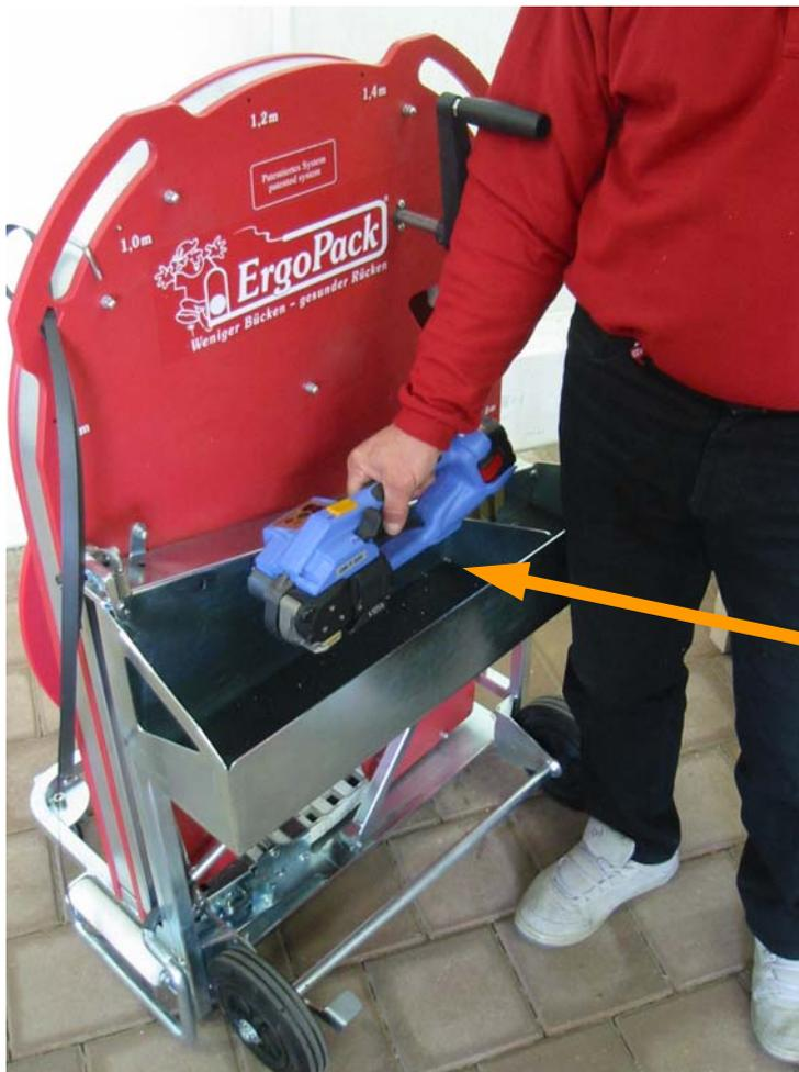
Legen Sie dann das Verschlussgerät in das Ablagefach
