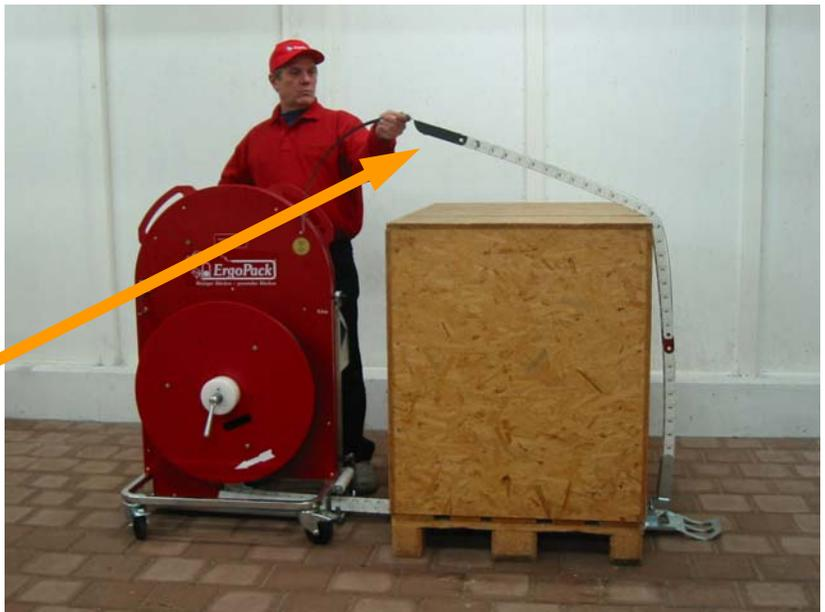
...und drehen Sie an der Kurbel entgegen dem Uhrzeigersinn die Kettenlanze zurück.
