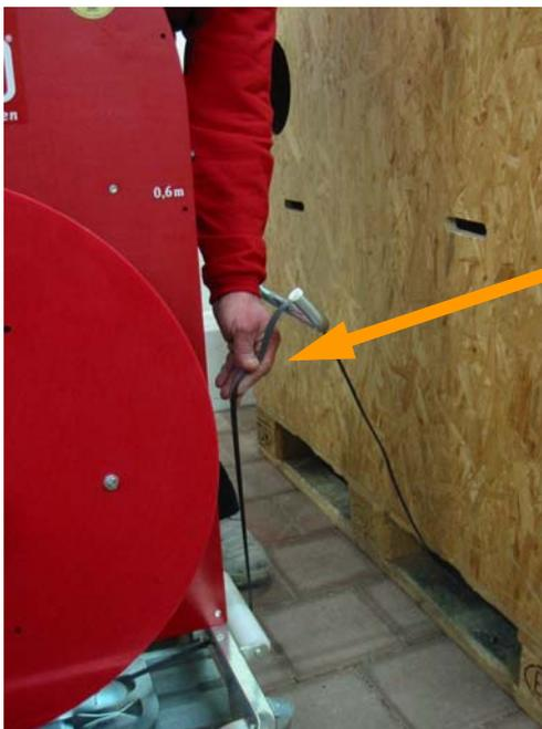
...sondern ca.10cm unterhalb des Bandhebers. Greifen Sie das Band mit der ganzen Hand und ziehen Sie dieses aus dem Gerät.
