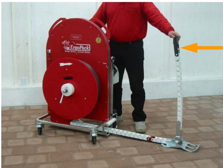
...und halten mit der linken Hand das Ende der Kettenlanze während Sie weiter an der Kurbel drehen.
